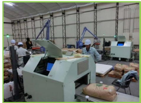
ベルトコンベア式検査機器による検査の様子
